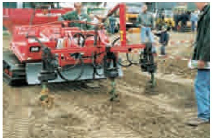
**Der Betrieb Neumann hatte den Neuson-Snowcat mit einem Dreifach-Erdbohrer ausgerüstet.**
