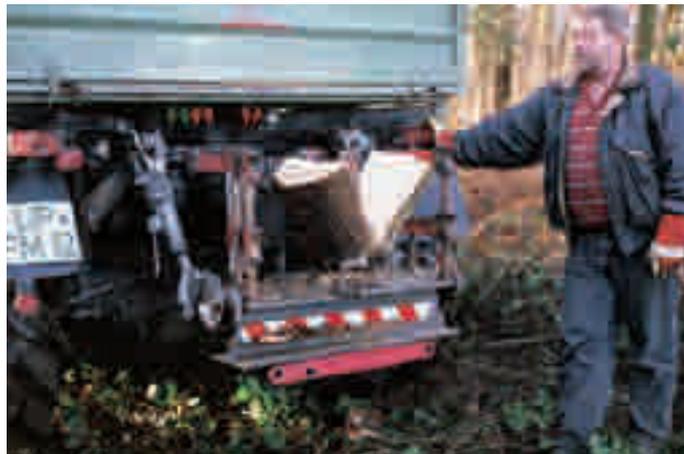
**Auf einer zwischen den Unterlenkern befestigten Schiene wird das Stammstück arretiert und dann hydraulisch gegen ein feststehendes Messer gedrückt; gezeigt vom GaLaBau-Betrieb Müssemeier.**
